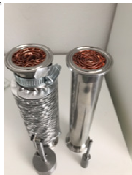
Tubes met vinnen aan de buitenkant en profielen aan de binnenkant
